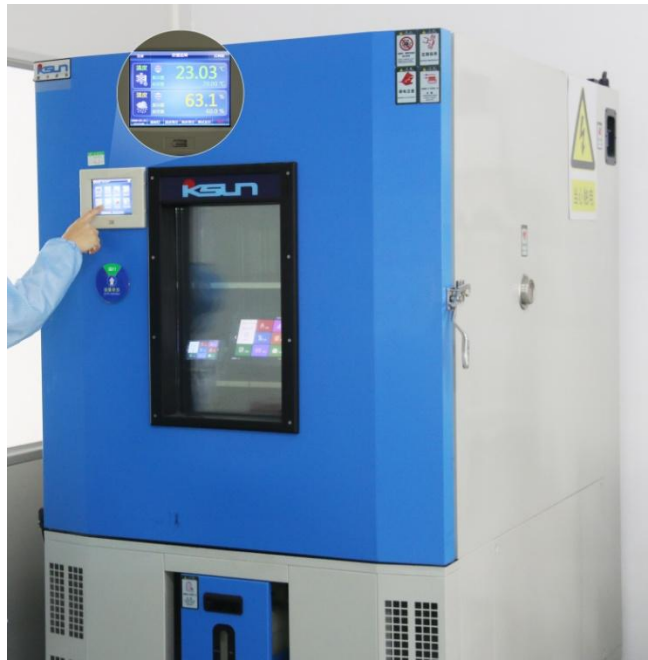
图 4-4 高低温老化测试图
